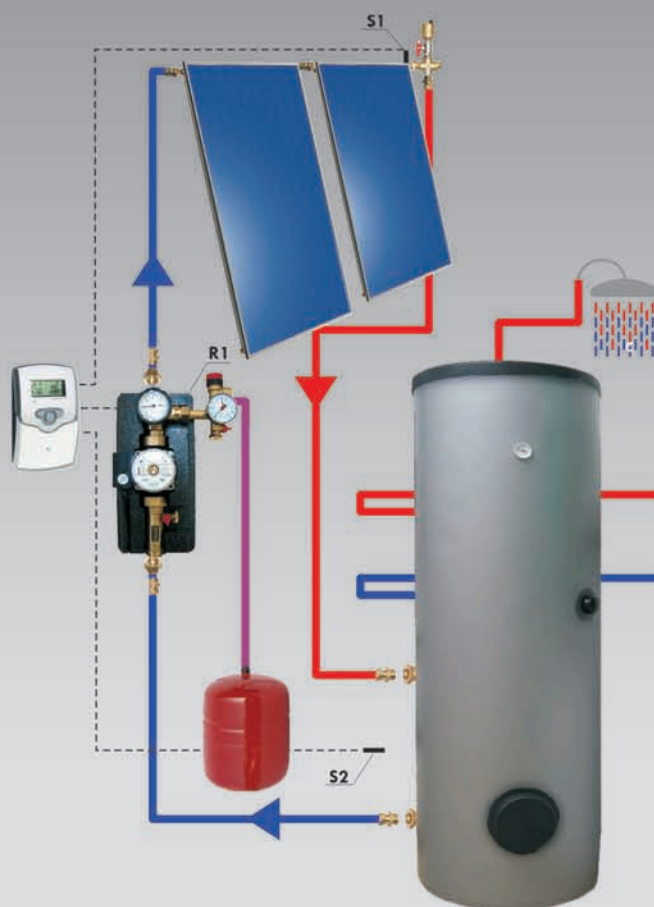
Hydraulické schéma zapojení solární sestavy
